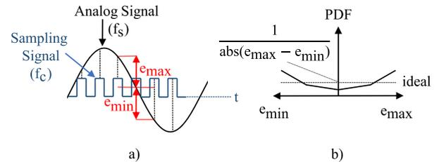
**FIGURE 3.** Sampling error: a)  $e_{max}-e_{min}$ , b) PDF of sampling error.
